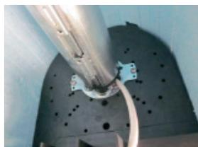
3 - Insérer l'embout télescopique dans le téton du coussinet, remettre la goupille et bloquer la bague d'arrêt
