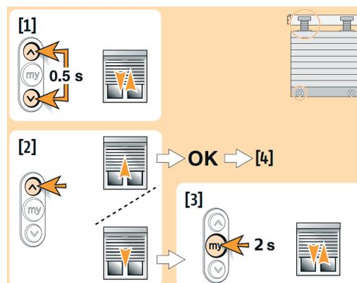
4 - Appuyer simultanément sur les touches «montée» et «descente» : bref mouvement du volet
