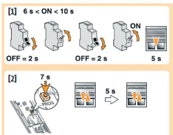
2 - Appuyer sur le bouton «prog» jusqu'à deux brefs mouvements du volet ( 7s )
